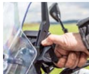
Plexi je výškově nastavitelné, stačí povolit robustní matice, což jde pohodlně v rukavicích i bez nich
